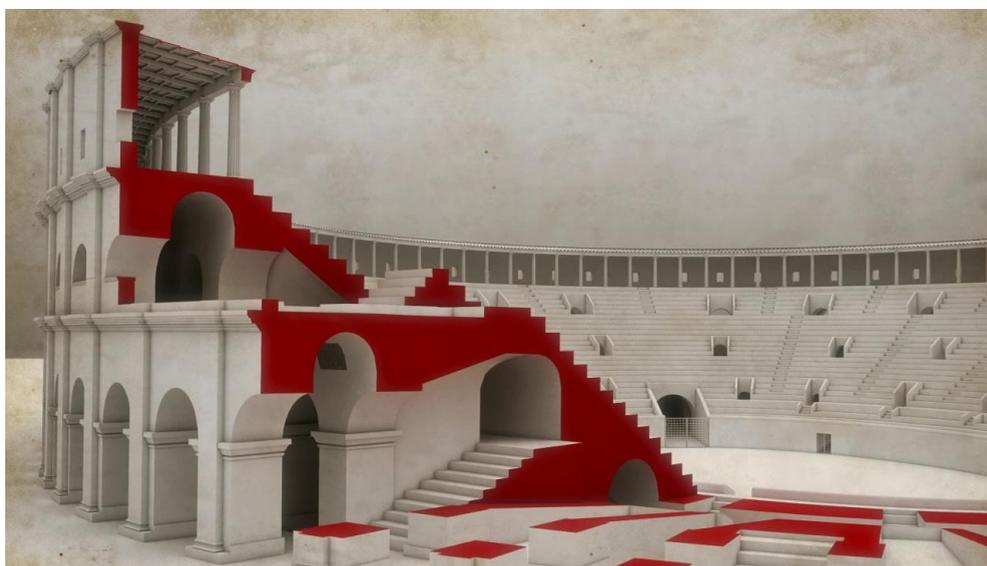
Figura 2. Sistema costruttivo dell'anfiteatro di Lecce. La sezione prospettica schematizza il complesso sistema di scale e corridoi di distribuzione.
