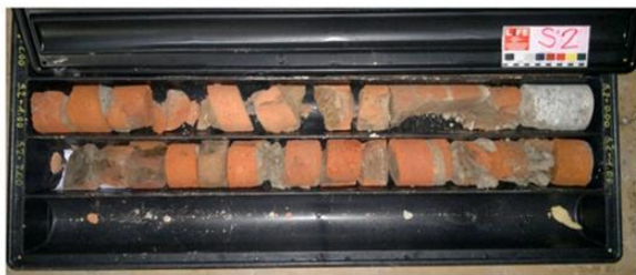
ID S2 - INDAGINE IN FONDAZIONE MEDIANTE CAROTAGGIO IN CONTINUO
