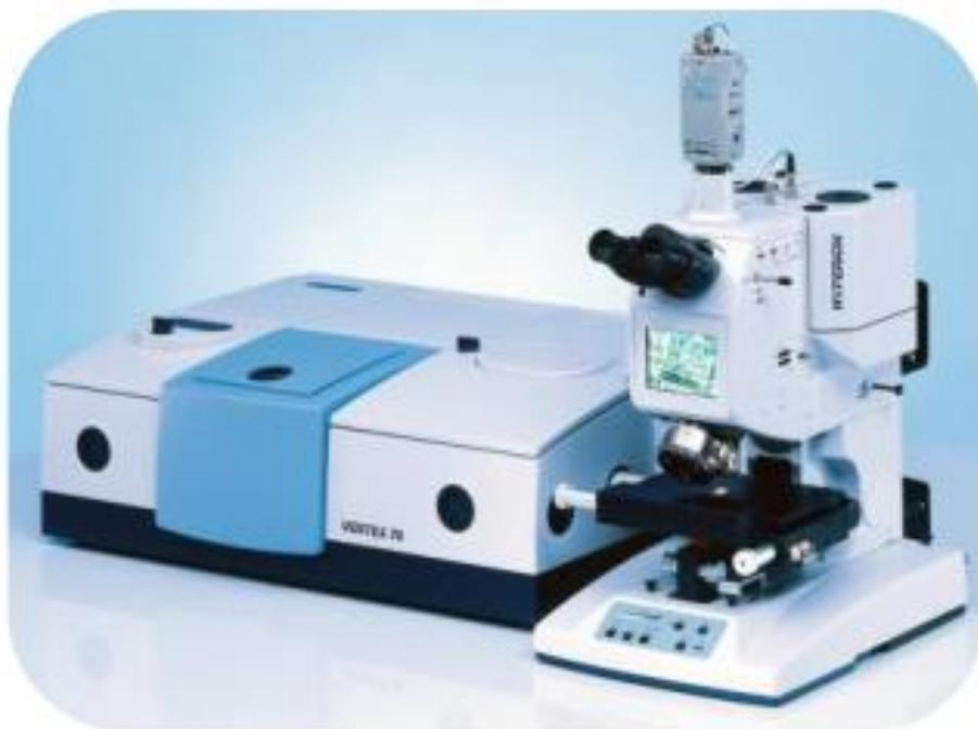
Un microscopio ottico però **non** è utilizzabile come microscopio IR: le lenti di cui è fatto il microscopio assorbono la luce IR. Un microscopio IR, quindi, può essere realizzato **solo** utilizzando ottiche a specchi.
